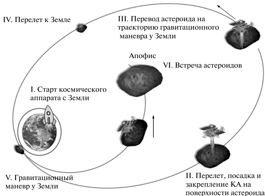
Рис. 1. Базовая концепция отклонения опасных астероидов.
